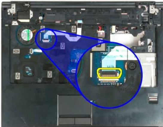
15. Irrota multimediapainikkeen aluslevyn datakaapeli pidikkeestä.
